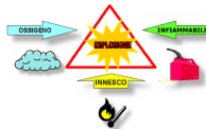
In caso di esplosione, i lavoratori sono messi in grave pericolo dagli effetti incontrollati delle fiamme e della pressione, sotto forma di irradiazione del calore, fiamme, onde di pressione e frammenti volanti, così come da prodotti di reazione nocivi e dal consumo nell'aria circostante dell'ossigeno necessario per la respirazione.
